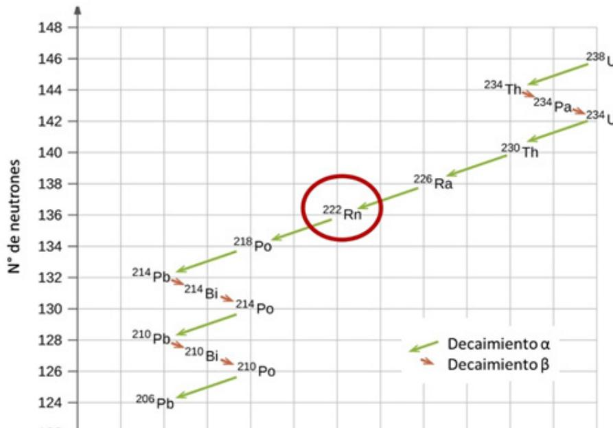
**Figura 1.** Cadena de desintegración del  $^{238}\text{U}$ . Los isótopos en la cadena vertical representan decaimiento alfa ( $4\text{He}^{2+}$ ) y los isótopos en cadena lateral decaimiento beta. Grolander, (2009)
